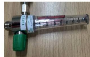
(D) รูปแสดง O_2 Flow meter ขนาด 70 LPM
