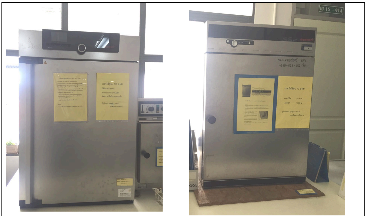
เครื่องอบไอร้อน (hot air oven) ติดป้ายเวลาและรอบการ เปิด/ปิด การใช้เครื่อง
